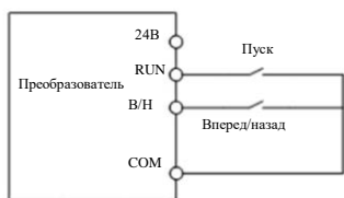
(a) Схема подключения двухпроводного управления (F00.03 = 0) (b) Логика вращения вперед/назад (F04.19 = 0, F00.03 = 0)
