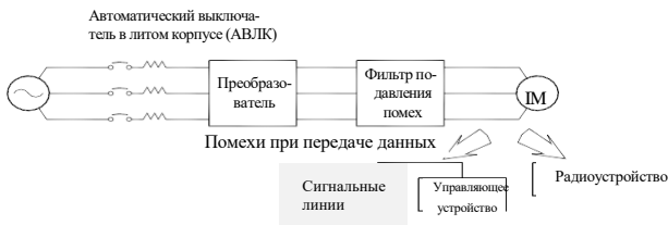
Рисунок 3-7. Установка фильтра подавления помех на выходной стороне
