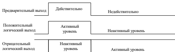
Рисунок 7-14. Диаграмма положительной и отрицательной логики цифровых выходов
