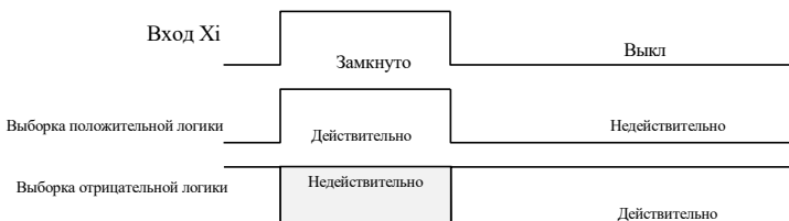
Рисунок 7-12. Диаграмма положительной/отрицательной логики цифровых входов
