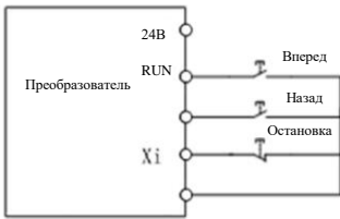
(a) Схема подключения трехпроводного управления (F00.03=2)
